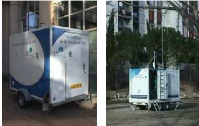
Figure 55 : Remorques de laboratoire mises en place à proximité du site de Malvézi
