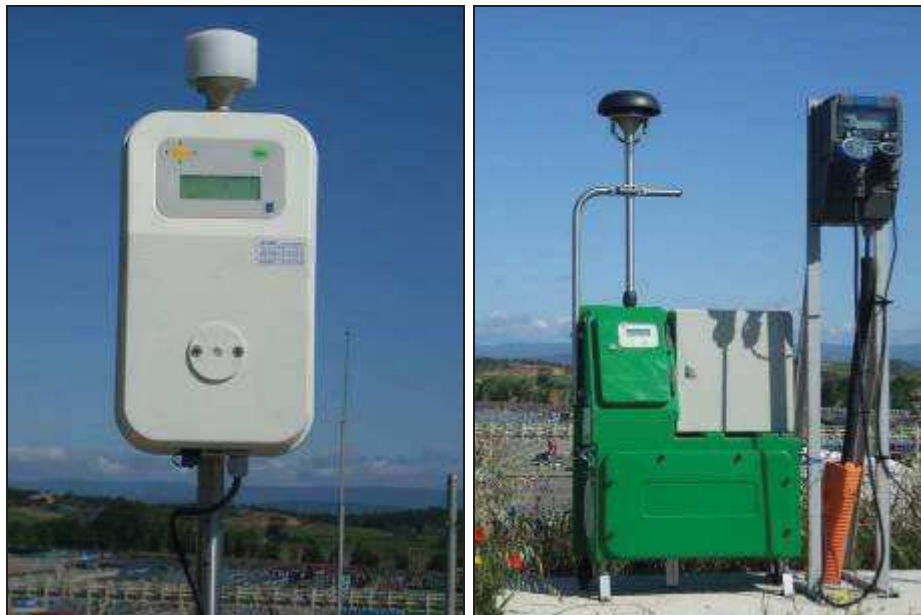
Figure VI. 3.5 : Stations de mesure de la contamination radioactive de l'air et de prélèvements des poussières atmosphériques pour analyse des radionucléides
