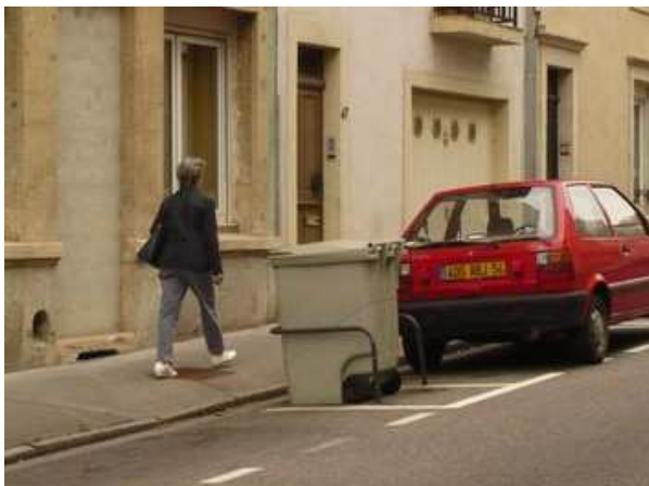
Neutralisation partielle d'une place de stationnement permettant de libérer les trottoirs et faciliter le ramassage des ordures ménagères
