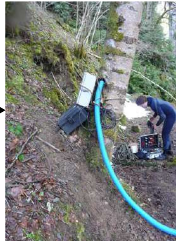
Photos 1 : Installations de l'appareillage destinée à l'estimation des volumes produits par la source de Merial
