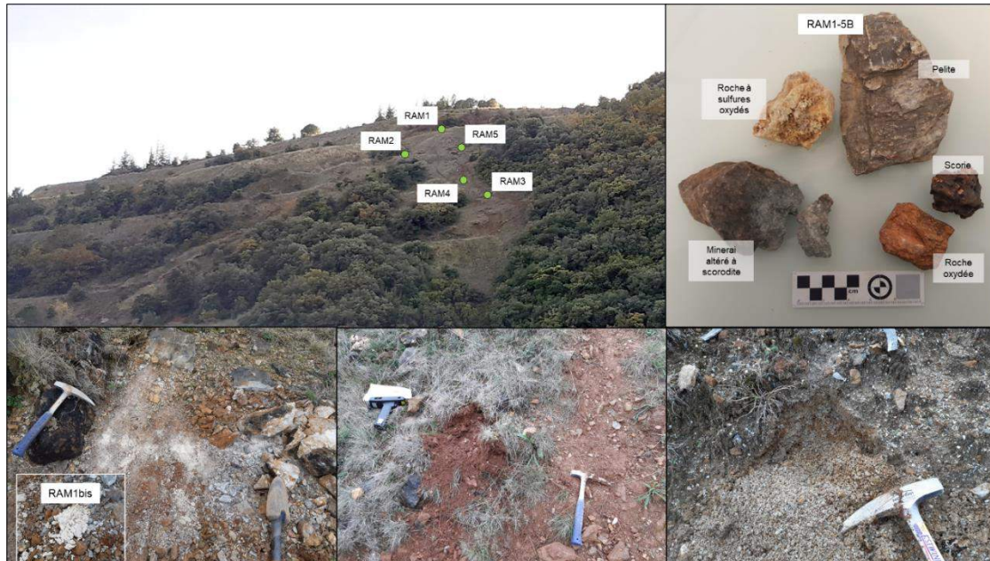
Figure 61. Photographies d'échantillons représentatifs de la zone d'impact à proximité de l'ancienne cheminée de la fonderie de la verse de Ramèle.
