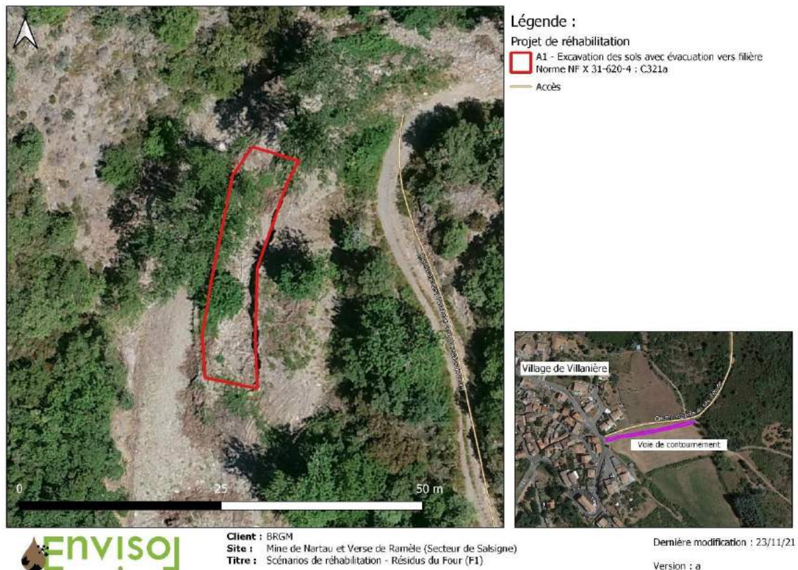
Figure 86. Scénario résidus de four 1 : excavation totale
