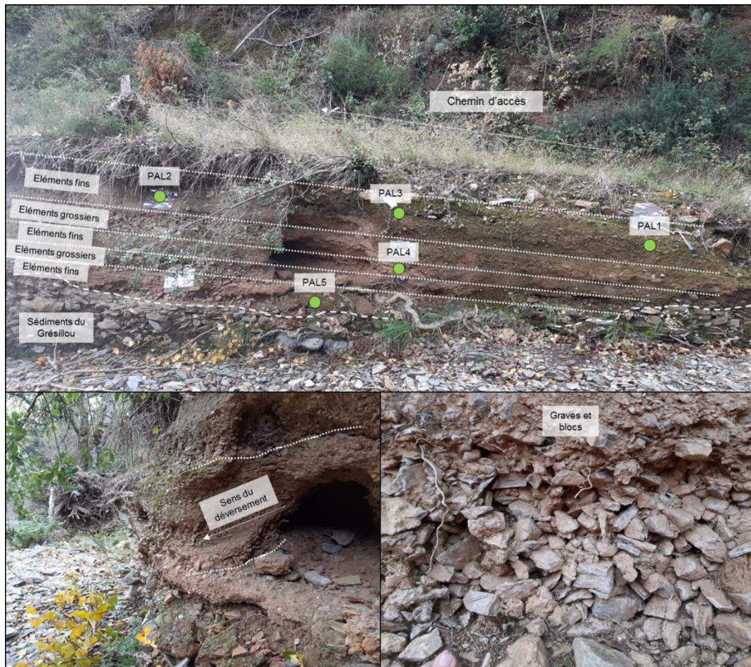
Figure 63. Photographies des matériaux situés au pied de la verse Ramèle érodé par le Grésillou
