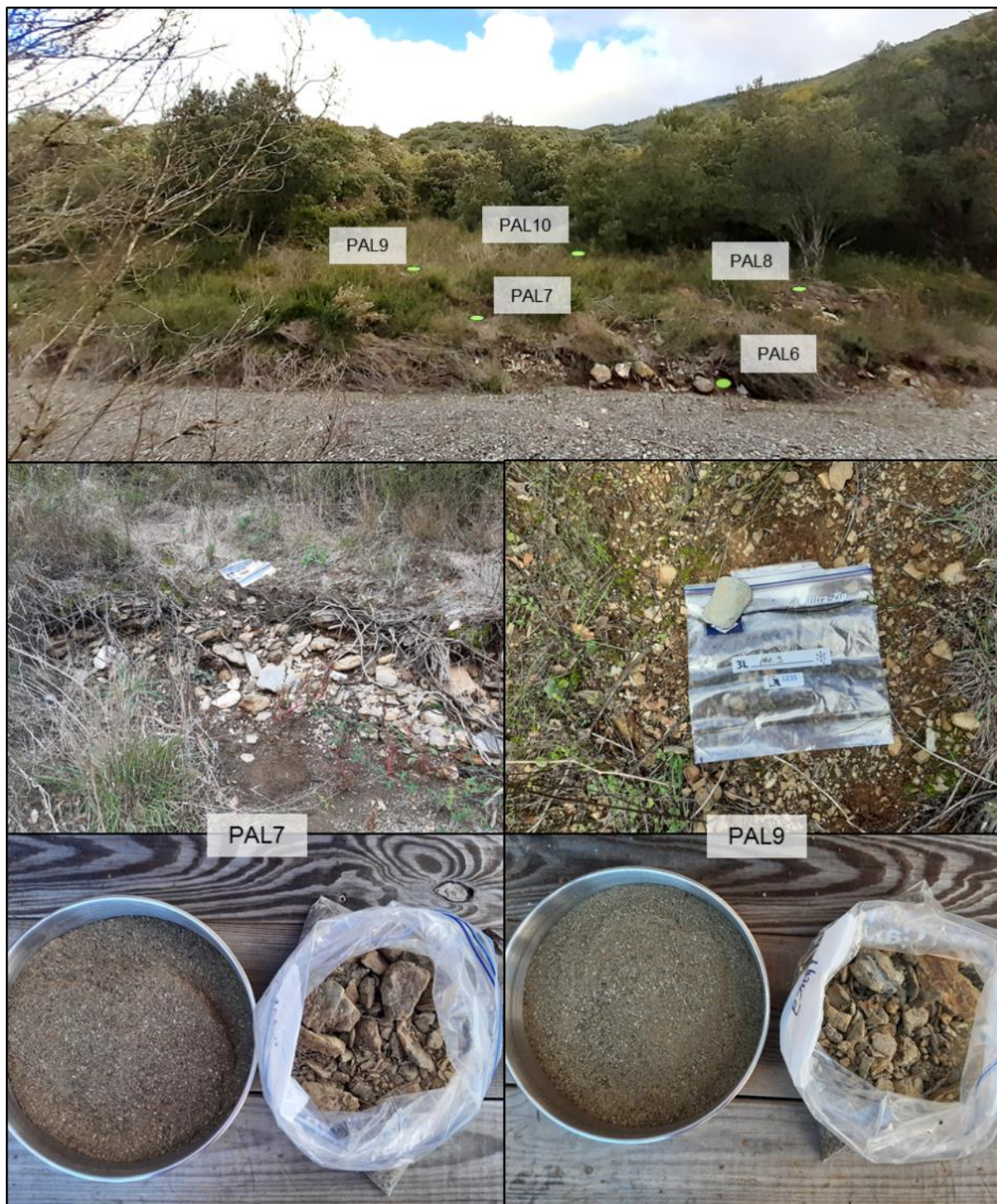
Figure 82. Photographie d'échantillons représentatifs des paléosédiments en zone d'inondation
