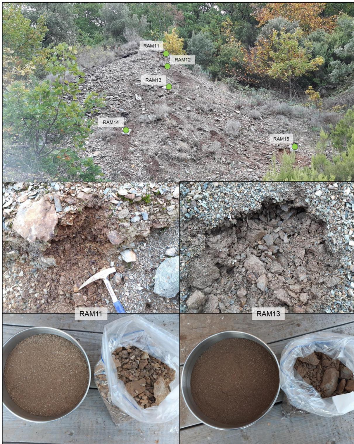
Figure 78. Photographie d'échantillons représentatifs des matériaux de la verse annexe de Ramèle
