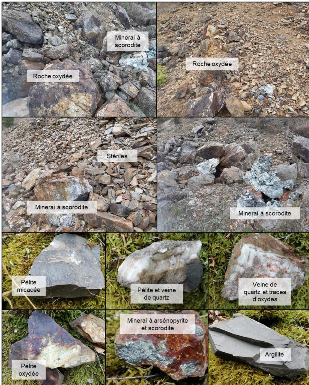
Figure 69. Photographies illustrant les blocs des talus de la verse Ramèle
