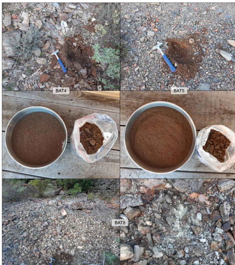
**Figure 41. Photographie d'échantillons représentatifs des bâtiments de Nartau. En bas à gauche : blocs rocheux oxydés et calcinés ; en bas à droite : blocs de minerai friable à scorodite (blanc/vert)**
