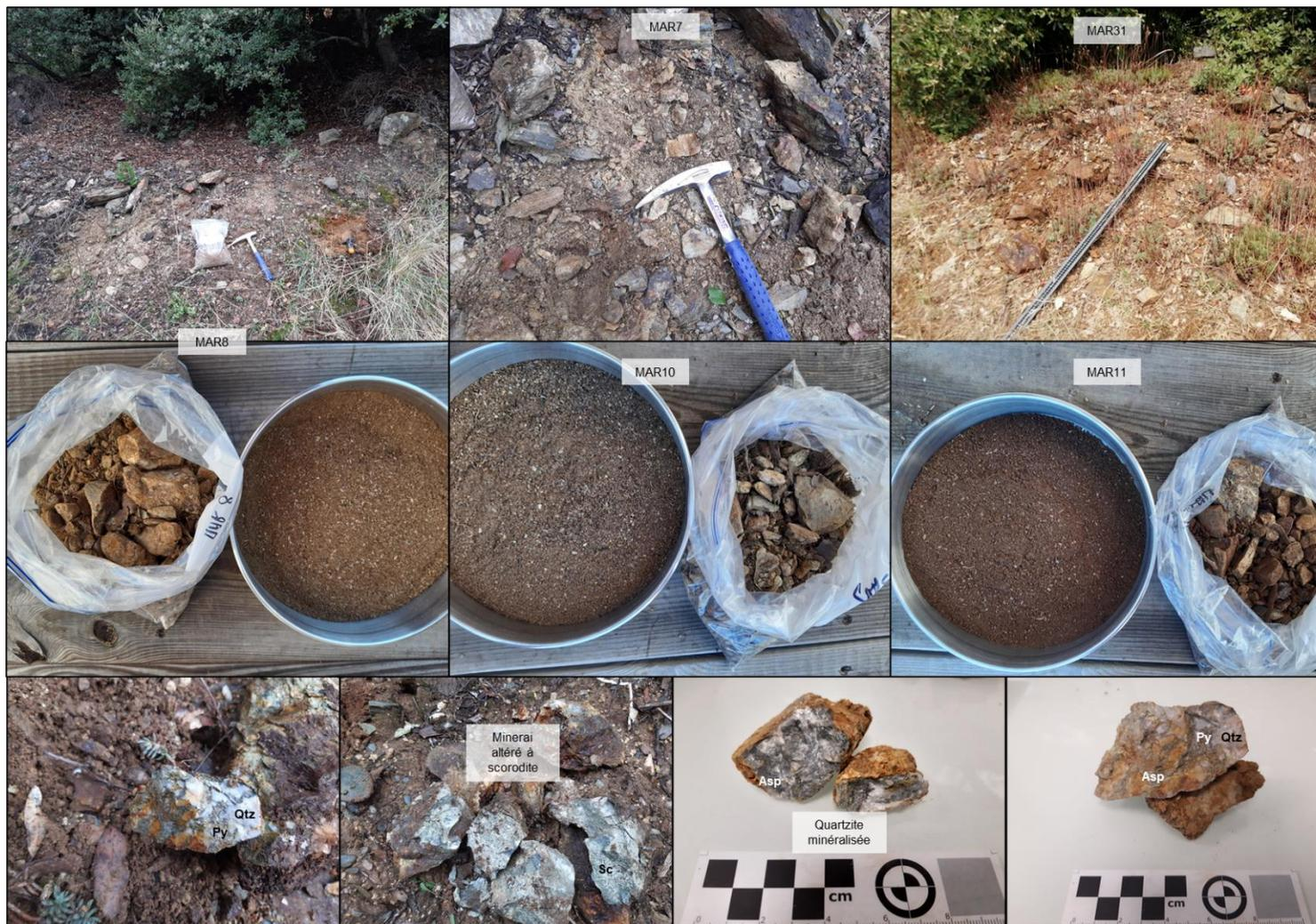
Figure 55. Photographies des tas matériaux de la plateforme Marty ; en haut : illustration des tas ; au milieu : échantillons tamisés représentatifs de chaque zone ; en bas : blocs minéralisés (Abréviations : Qtz : quartz, Py : pyrite, Asp : arsénopyrite, Sc : scorodite).
