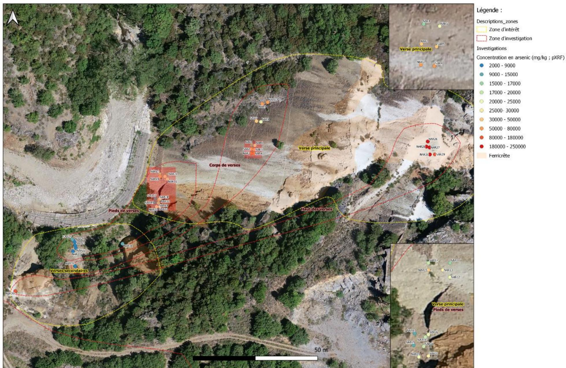
Figure 36. Cartographie des concentrations en arsenic au droit des verses de Nartau
