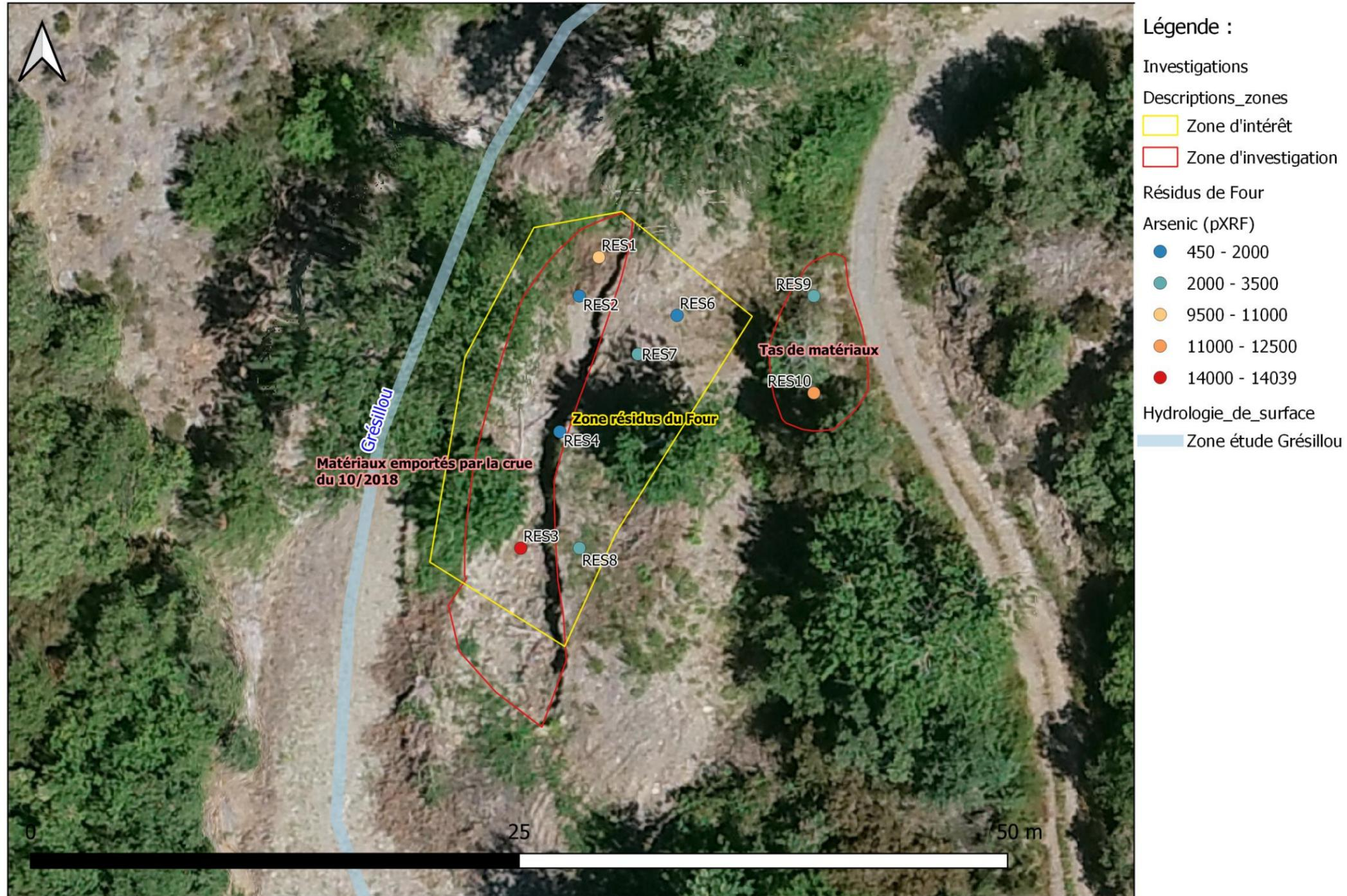
Figure 48. Cartographie des concentrations en arsenic au droit de la zone des résidus de four
