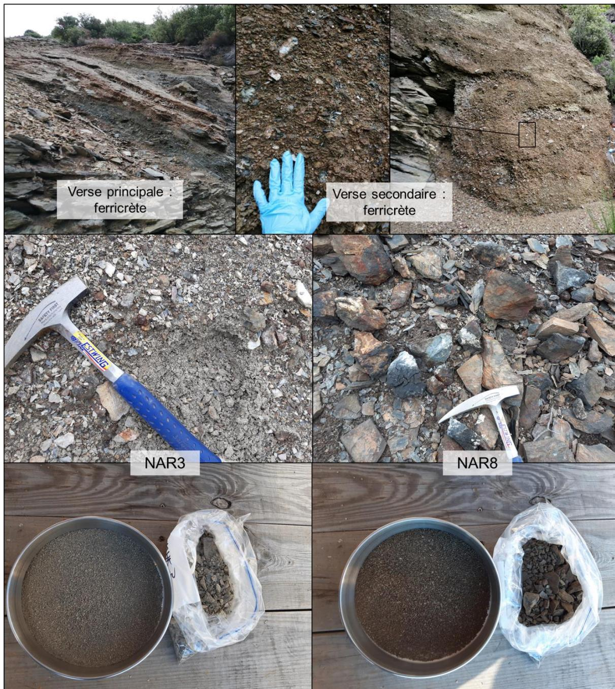
**Figure 32. Photographie d'échantillons représentatifs du corps de verse de Nartau ; en haut : ferricrète sur les verse principale et secondaire ; au milieu : échantillons représentatifs à l'affleurement ; en bas : échantillons représentatifs tamisés.**
