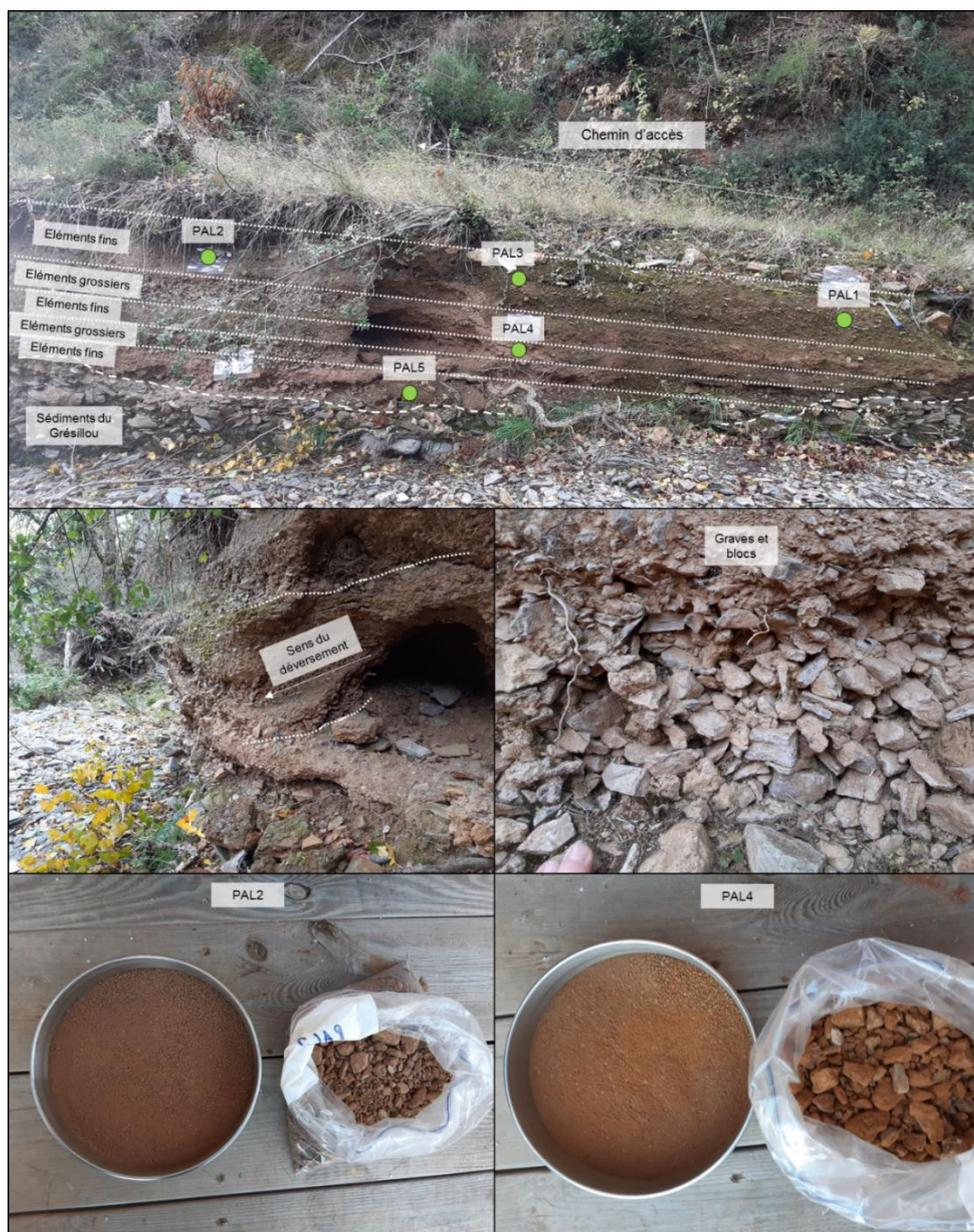
**Figure 68. Photographies des matériaux situés au pied de la vers Ramèle érodé par le Grésillou**
