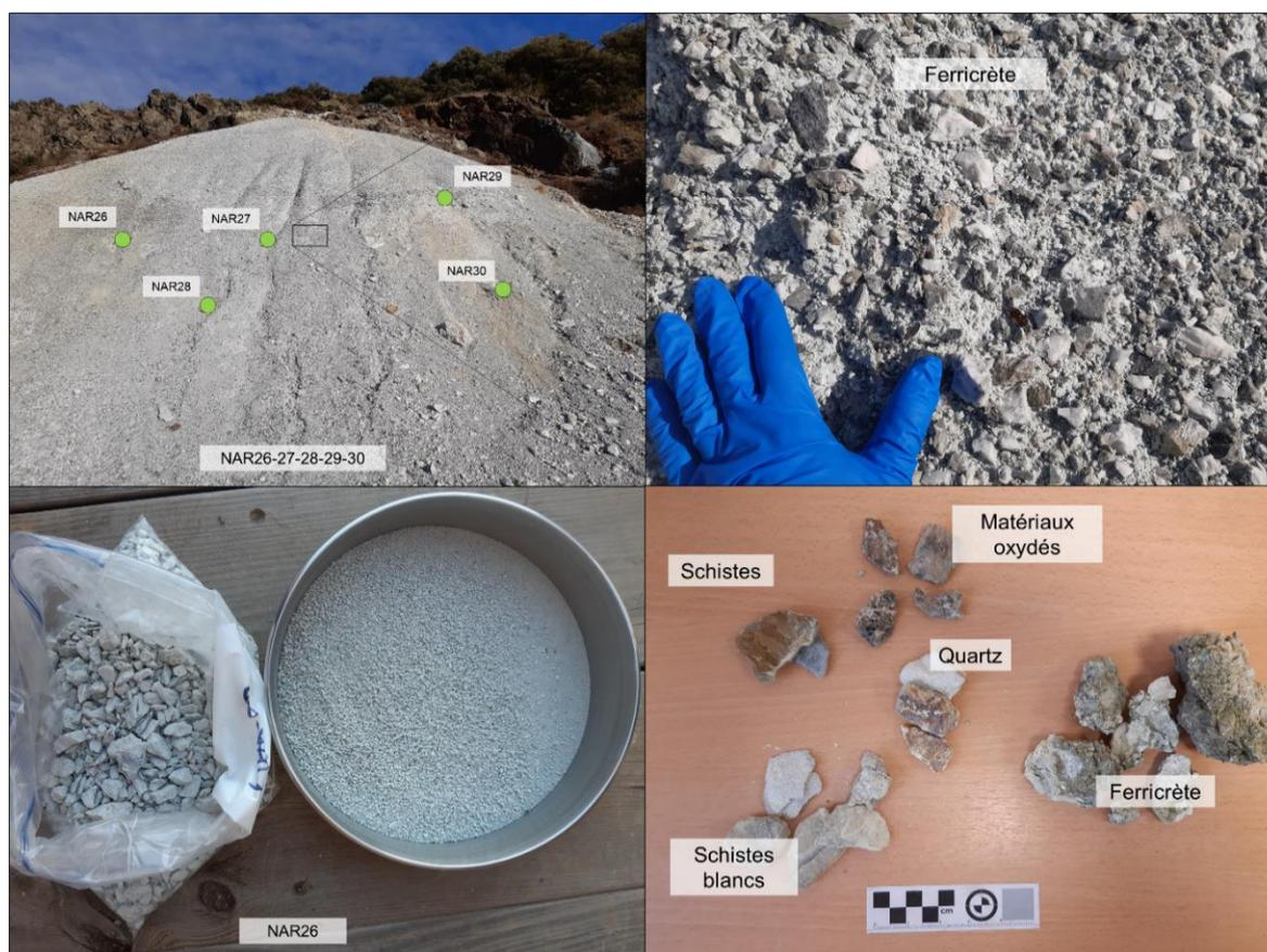
**Figure 34. Photographie d'échantillons des matériaux du haut des verses de Nartau**
