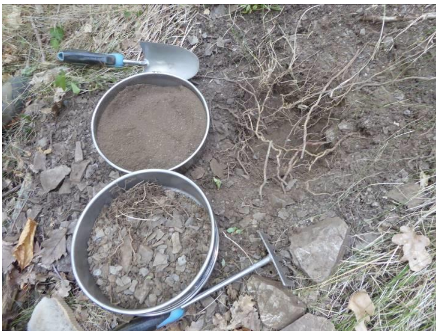
Figure 12 : Site d'échantillonnage dans les schistes de la zone axiale avec un sol léger, fin et des refus de tamisage composés de plaquettes de schiste.
