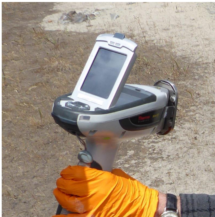
Figure 8 : Spectromètre pXRF NITON® XL3t980.
