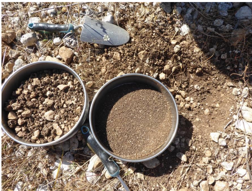
Figure 16 : Prélèvement d'un échantillon de sol dans une formation de calcaire lacustre du domaine Tertiaire. L'échantillon tamisé contient des particules d'argiles et des fragments de calcaire et le refus de tamisage contient des fragments grossiers de calcaires et des agglomérats consolidés d'argiles.
