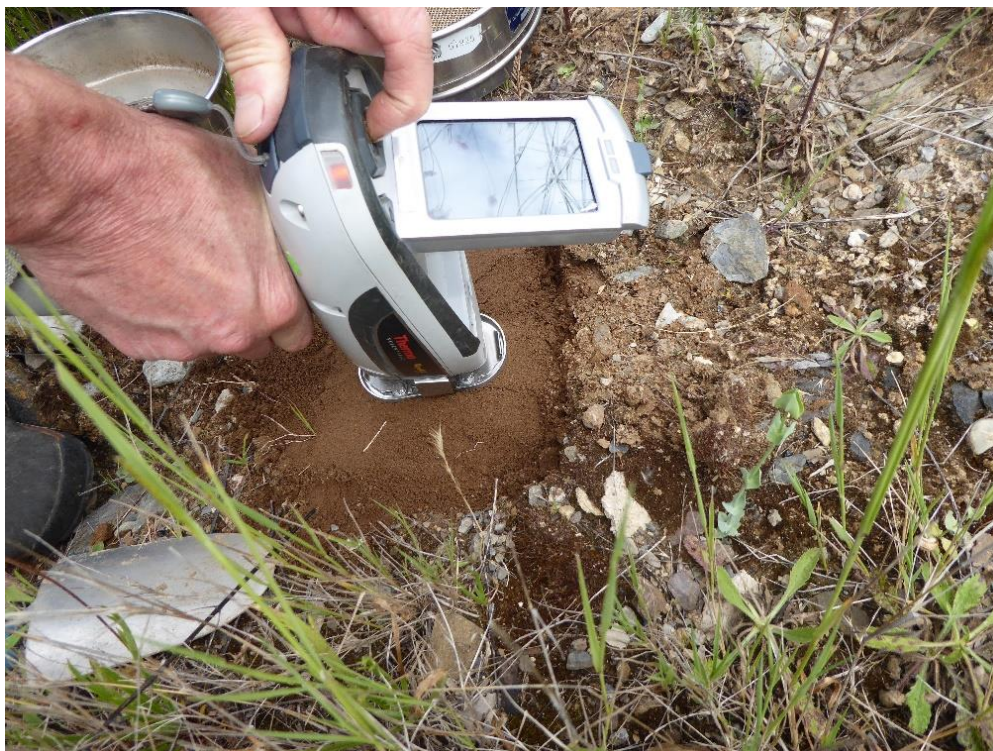
Figure 7 : Analyse au pXRF sur un échantillon préparé.
