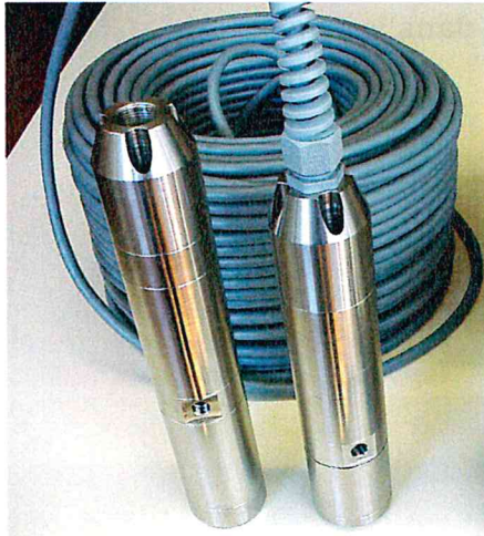
Sonde fluorimétrique GGUN FL24 pour forage (Albillia)
