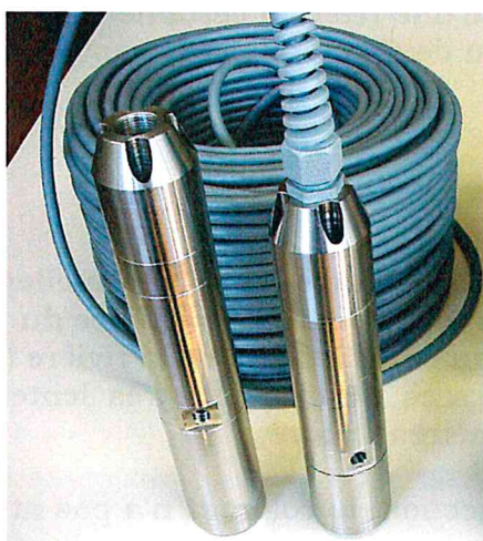
Sonde fluorimétrique GGUN FL24 pour forage (Albillia)
