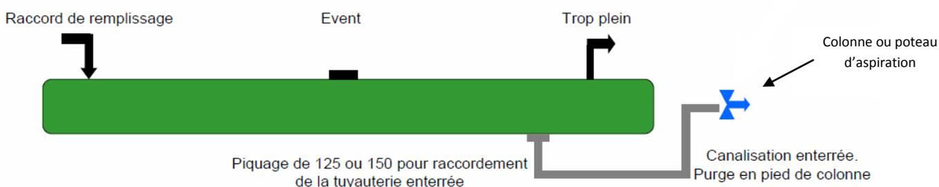
La capacité de la réserve doit être indiquée sur le coté de la réserve accessible aux engins de secours. Les bâches à eau régulièrement soumises au gel doivent être surdimensionnées pour prendre en compte la gangue périphérique non utilisable.
