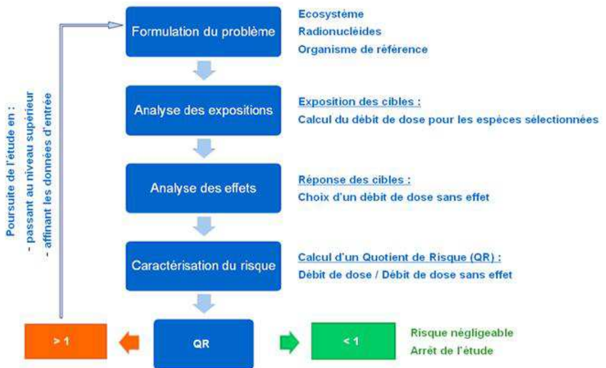
Figure 1 : Schéma de principe de l'outil ERICA
