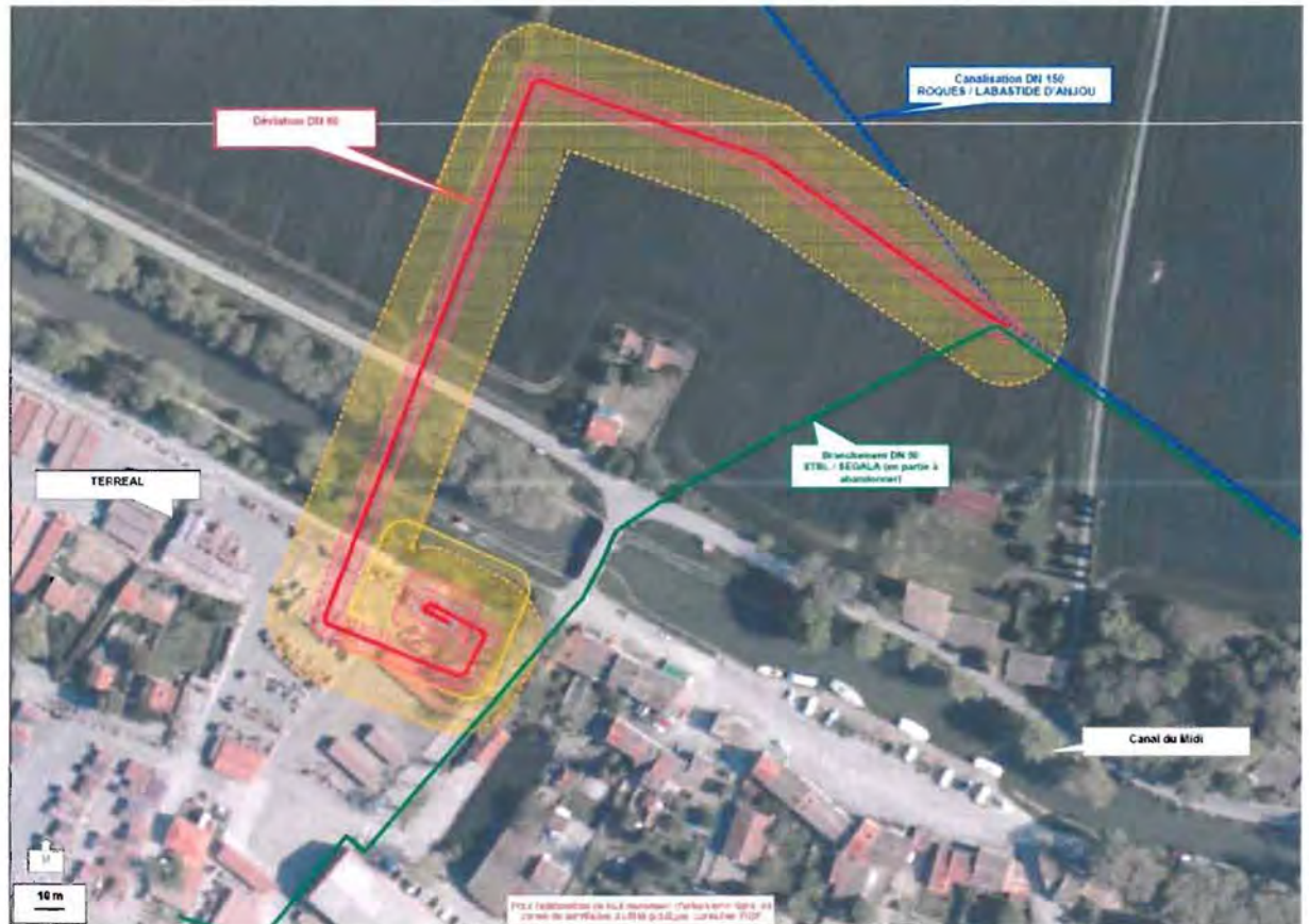
Carte 1 : Distances des servitudes d'utilité publique pour la canalisation en DN80 d'une longueur de 480 m à Segala et le poste de livraison « Saint-Gobain-Terreal » sur la commune de Labastide d'Anjou
