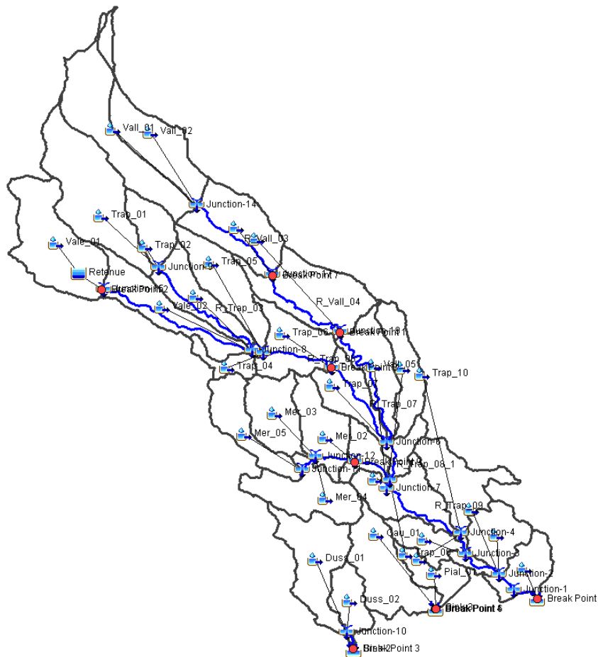
Schéma du modèle hydrologique sous HEC-HMS
