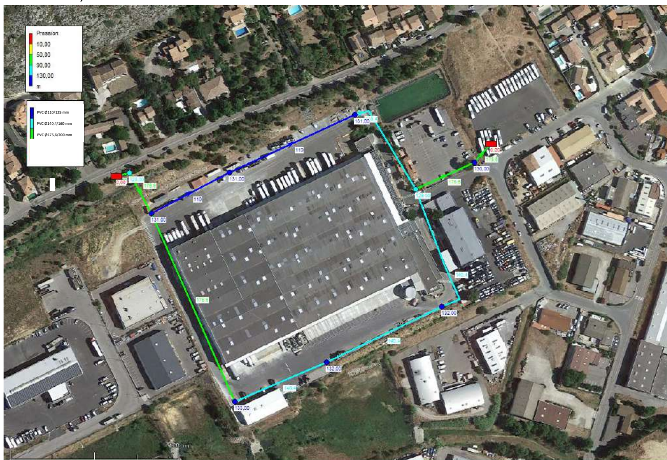
Pièce graphique 5 : Présentation du dimensionnement du réseau proposé
