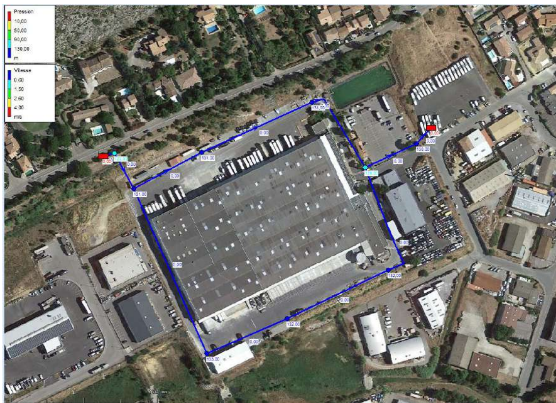
Pièce graphique 6 : Modélisation du réseau proposé en statique – sans débit d’appel sur les PI
