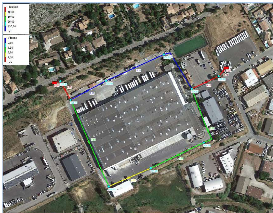
Pièce graphique 7 : Modélisation du réseau proposé en dynamique – avec application des débits d’appels sur les PI
