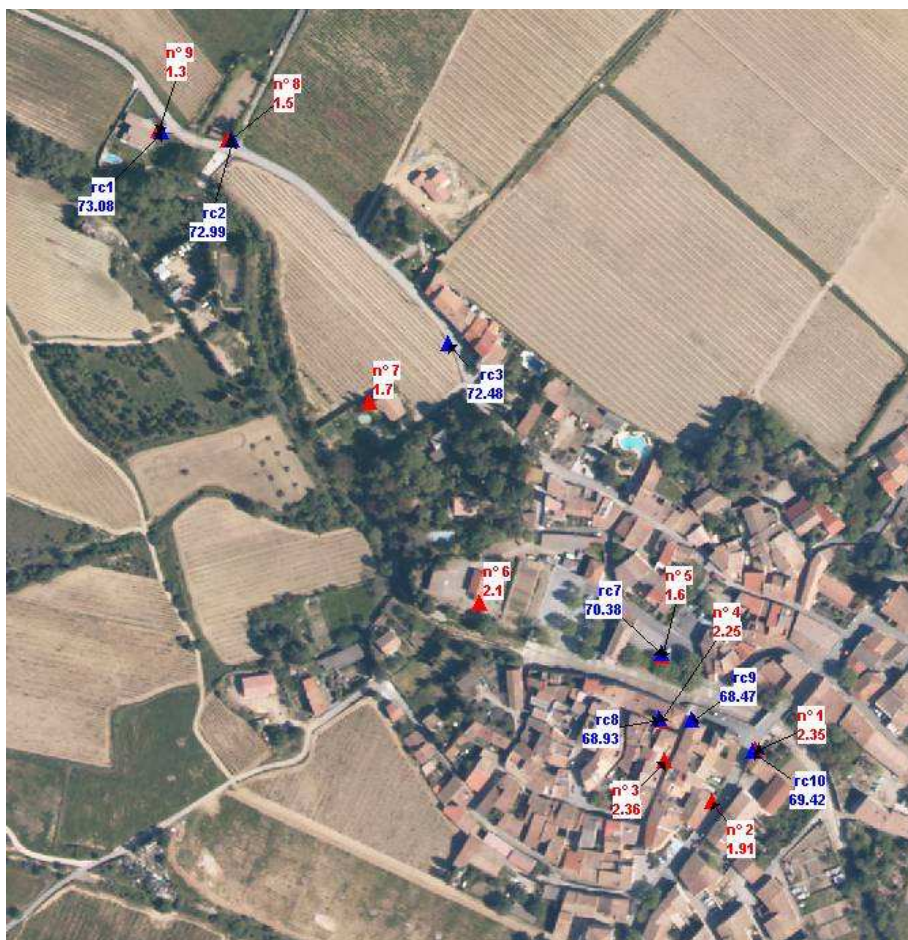
Figure 5 : Localisation des PHE dans le cadre de la mission « SAFEGE » (en bleu)
