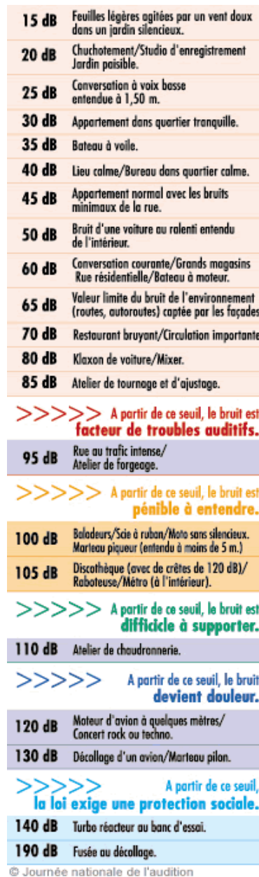
Figure 81 : Echelle des sons
