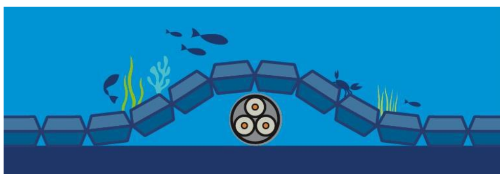
Figure 20 : Le matelas béton (autre protection externe possible)
