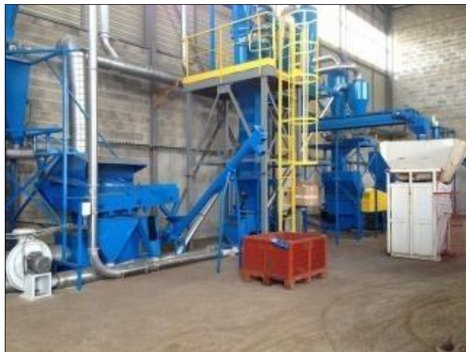
Figure 38 : Unité de broyage de câbles
