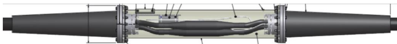
Figure 11 : Exemple de jonction sous-marine
