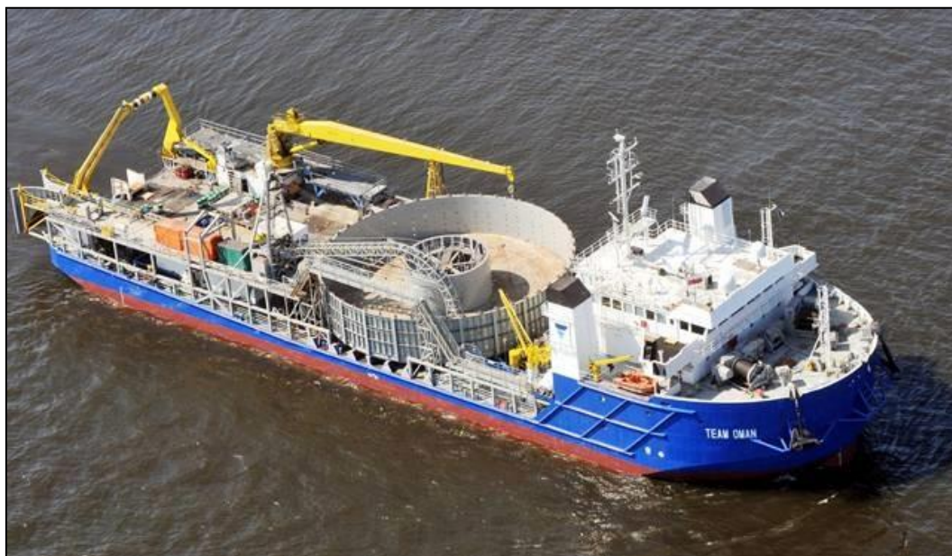
Figure 22 : Illustration d'un navire d'installation des câbles
