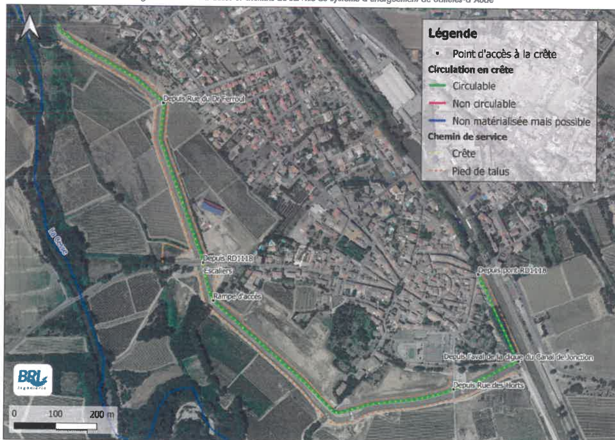
Figure 12 : Voies d'accès et chemins de service du système d'endiguement de Sallèles-d'Aude
