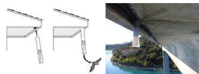
Illustrations de dispositif anti-retour à mettre en place à hauteur des potentialités identifiées (Sources : schéma - GCG, 2014 ; photo - Naturalia)
