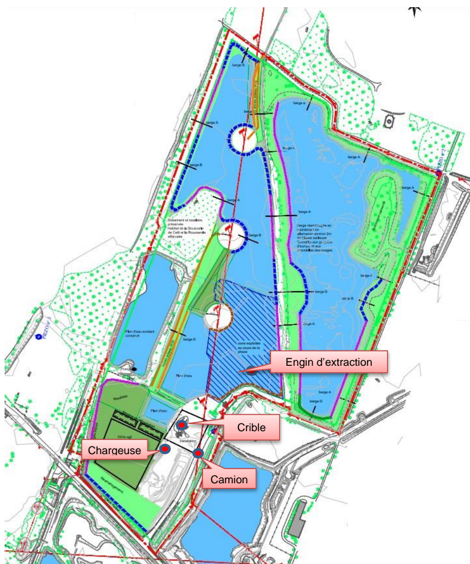
Localisation des sources prises en compte dans la simulation de la phase 5
