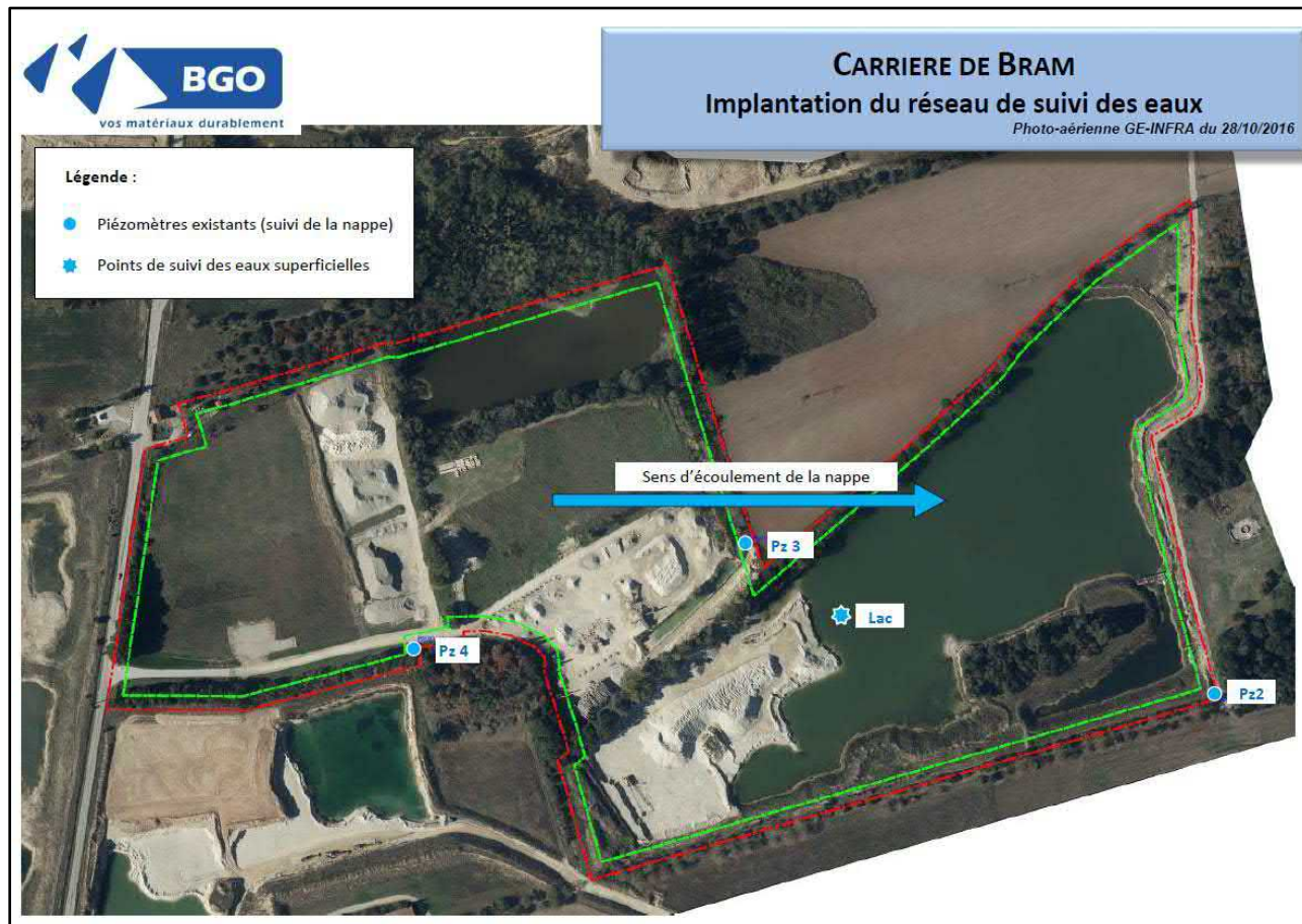
Figure 39: Implantation du réseau de suivi des eaux sur la carrière actuelle
