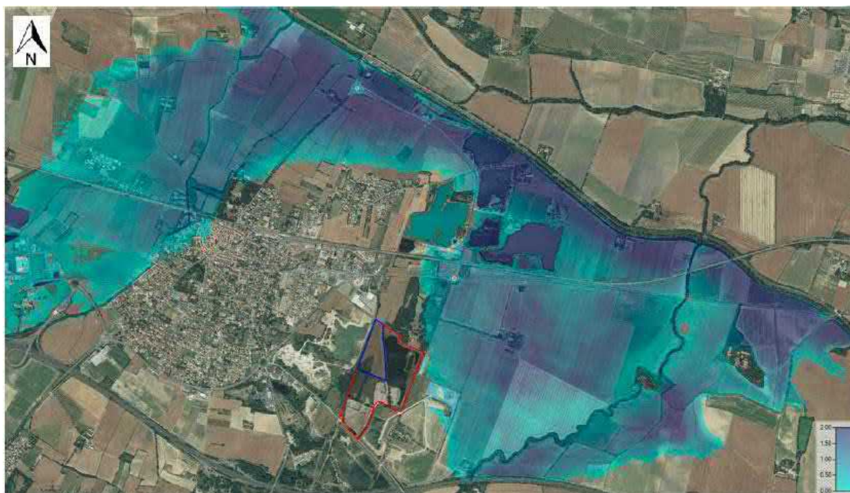
Figure 11 : Inondabilité à l'état actuel en crue centennale
