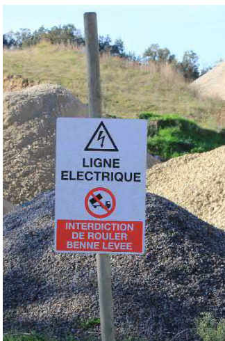
Figure 55 : Exemple de panneau rappelant l'interdiction de rouler benne levée sur le site GAIA de Bram
