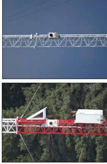
Figure 25 : Clichés du positionnement d'un module Batcorder autonome sur mât de mesure
