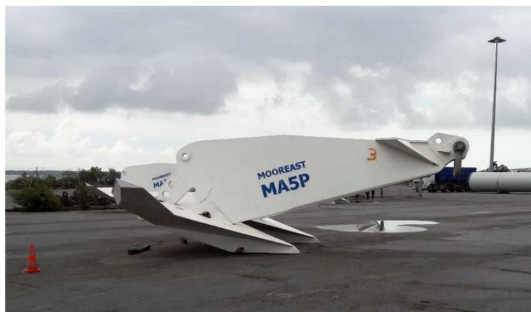
Figure 28 : Exemple d'ancre conventionnelle (Floatgen)
