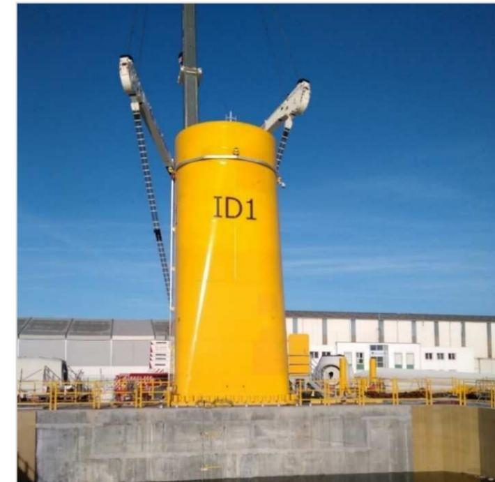
Figure 46 : Dispositif de signalisation maritime situé sur la pièce de transition (Floatgen)
