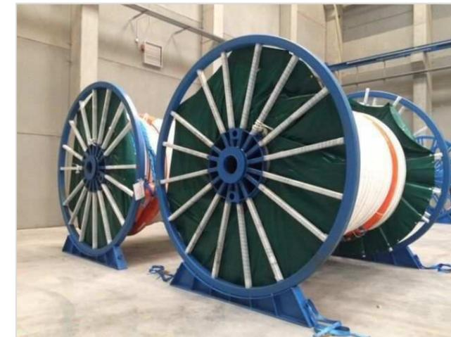
Figure 25 : Exemple de ligne d'ancrage en polyester (Floatgen)
