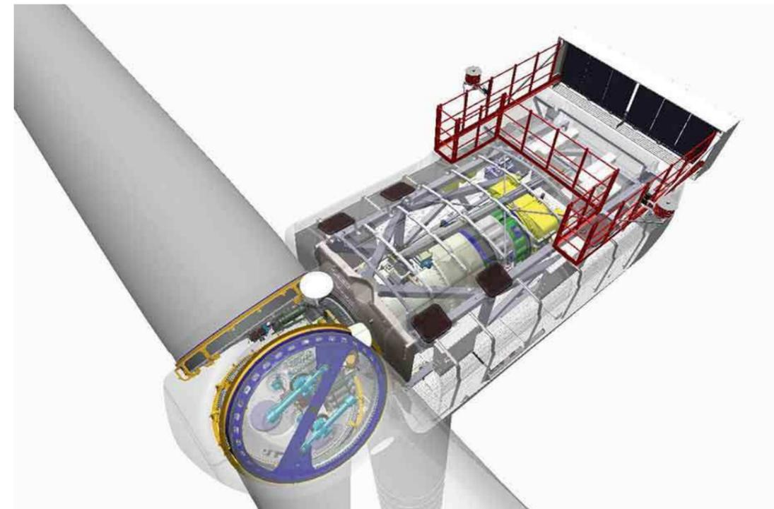
Figure 21 : Vue 3D de l'intérieur d'une éolienne MV164 de MVOW
