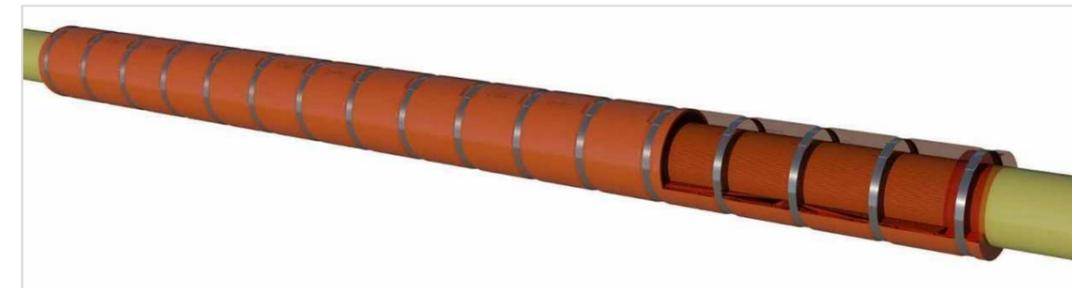
Figure 29 : Exemple de protection URADUCT sur câble inter-éolienne
