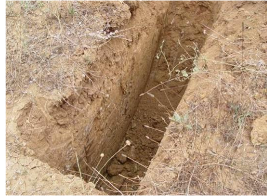
Fouille de sondage
