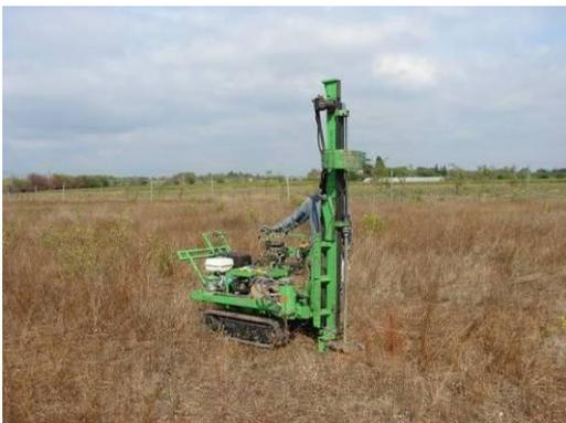
**Sondage au pénétromètre**
