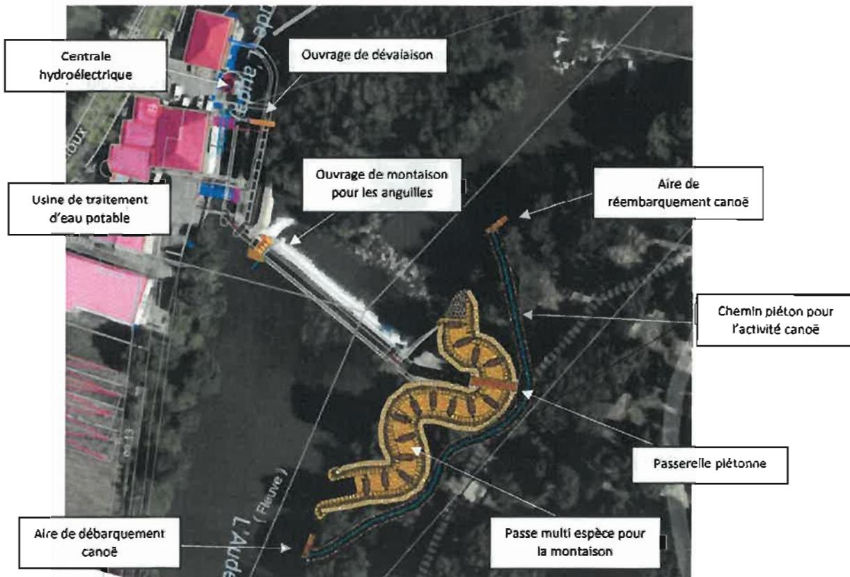
Le seuil de Maquens permet d'alimenter sur sa partie située en rive gauche d'une part une usine de traitement de l'eau potable et d'autre part une usine hydroélectrique, toutes deux protégées par une drome.
