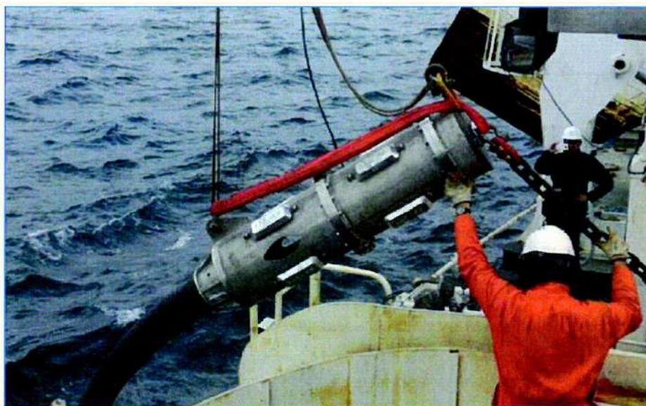
Figure 7 : Exemple de jonction sous-marine type « dry-mate »
