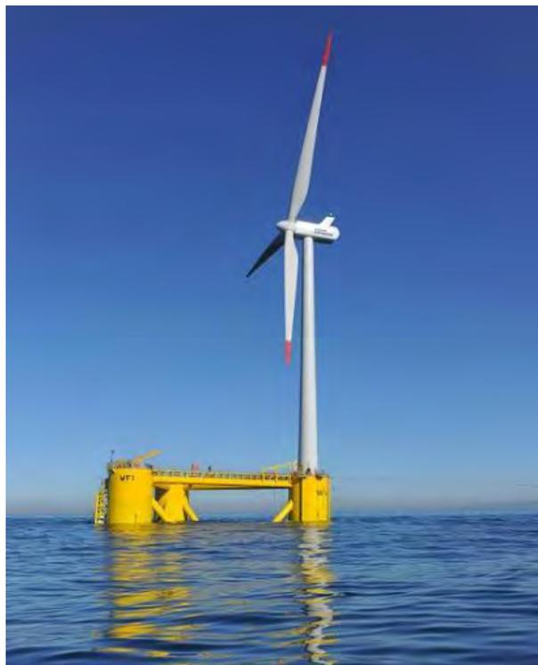
*Photographie 2 : Prototype WF1 (Source : EDPR)*
