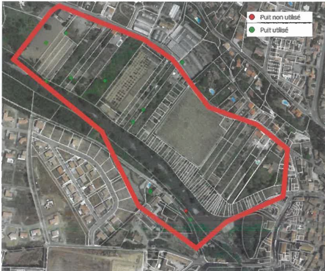
Figure 76 : zone de compensation des puits (surcreusement sous réserve de constat contradictoire avec le syndicat)
