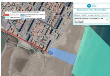
La zone d'atterrissage est le lieu où s'effectue la jonction entre le câble sous-marin et le câble souterrain. Elle comprend l'estran et la partie terrestre accueillant la chambre de jonction dite « chambre d'atterrissage ».
