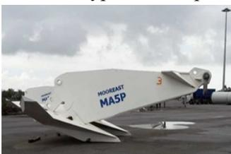
La largeur de la partie plane de l'ancre mesure environ 8,5 m avec une hauteur d'environ 3,6 m et pour un poids total d'environ 30 t par ancre.
