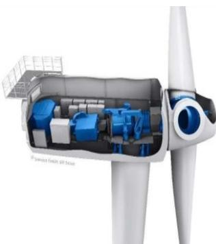
La nacelle contient des éléments structurels (châssis, couplages du rotor, roulements), des composants électromécaniques (génératrice, système d'orientation au vent, système d'ajustement des pales) et des éléments de sécurité (éclairage, extincteurs, freins).
