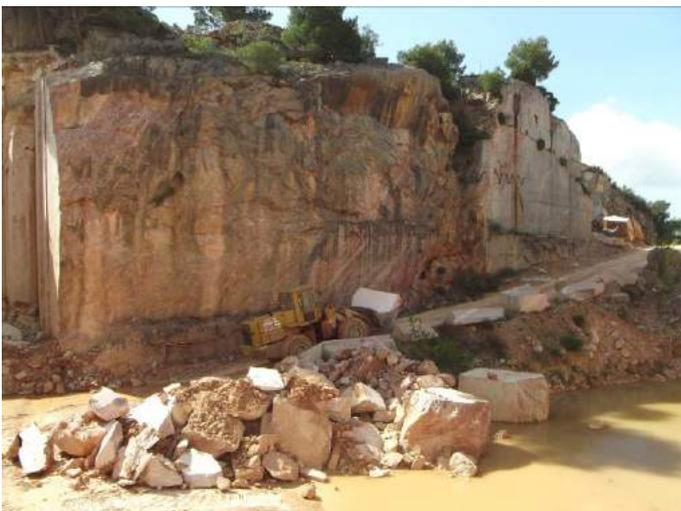
Séquence de photographies illustrant le transfert des blocs découpés depuis la zone d'extraction jusqu'à une aire de transit. Ils seront ultérieurement chargés sur des camions spécialement équipés pour être dirigés vers l'usine de carrare en Italie.
