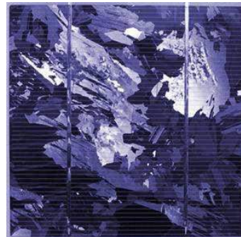
Cellule de silicium polycristallin
