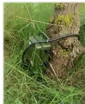
Enregistreur automatisé de type SM4 installé sur l'aire d'étude - Photo in situ
