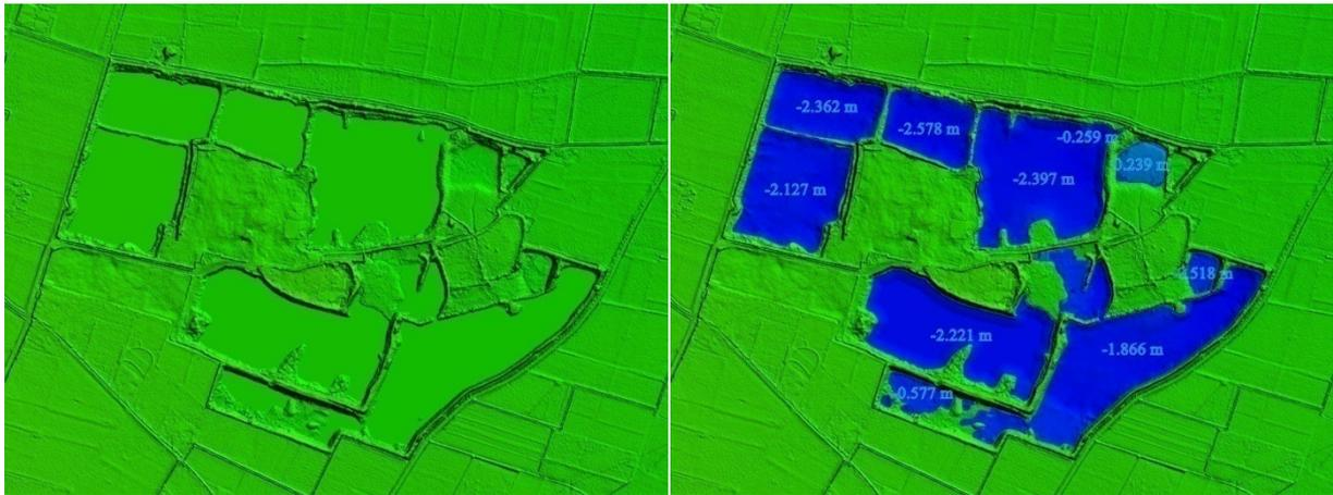
Figure 7 - bathymétrie des gravières : représentation du MNT du TRI (gauche) ; avec intégration des levés bathymétriques (droite) et indication des profondeurs moyennes des gravières
