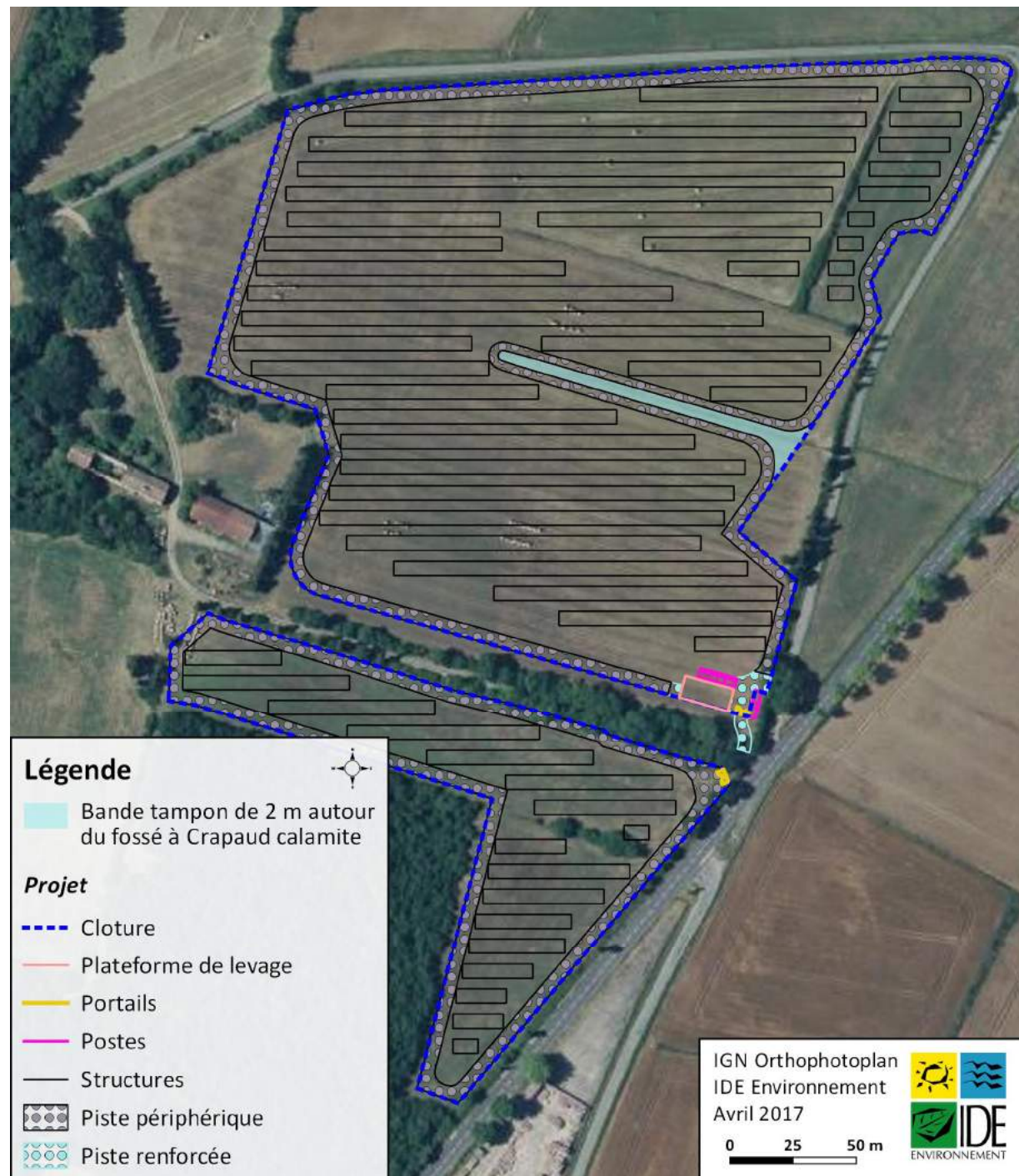
Figure 89 : Mise en place de bande tampon de 2 m autour du fossé à Crapauds calamites.
