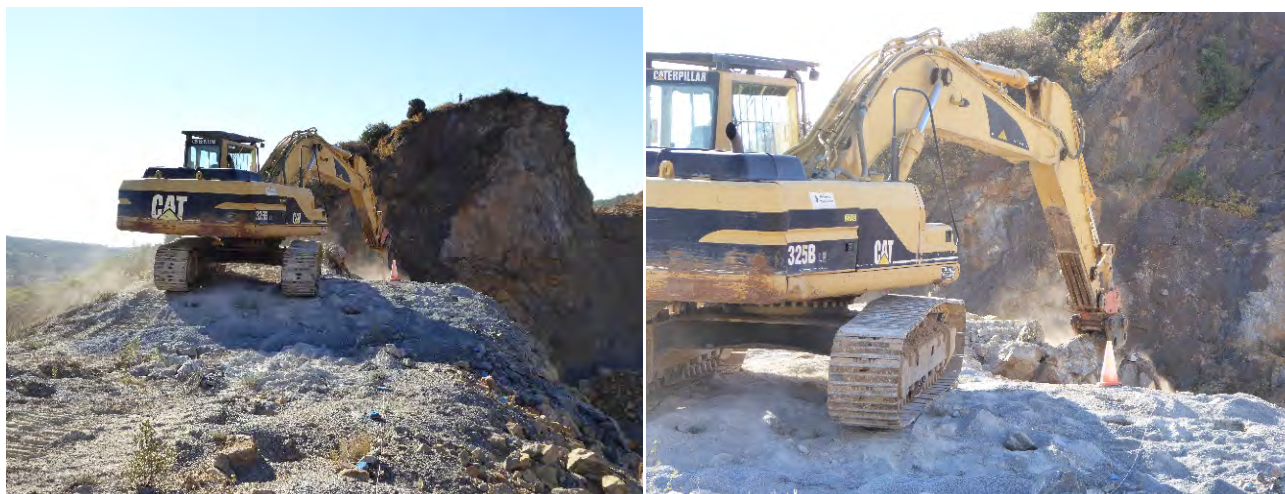
Extraction avec la dent de déroctage
