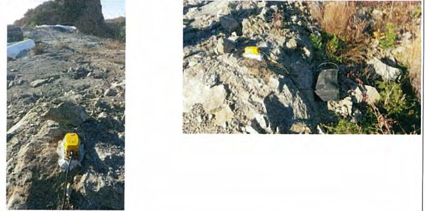
Capteur Versant, le plus proche du tir (Deltaseis 110) :
