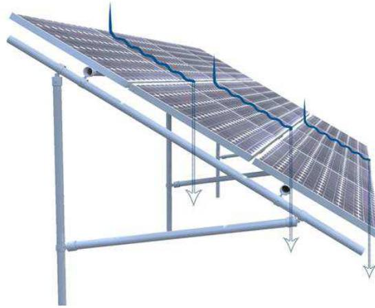
**Schéma de principe de l'écoulement de l'eau pluviale entre les panneaux**
