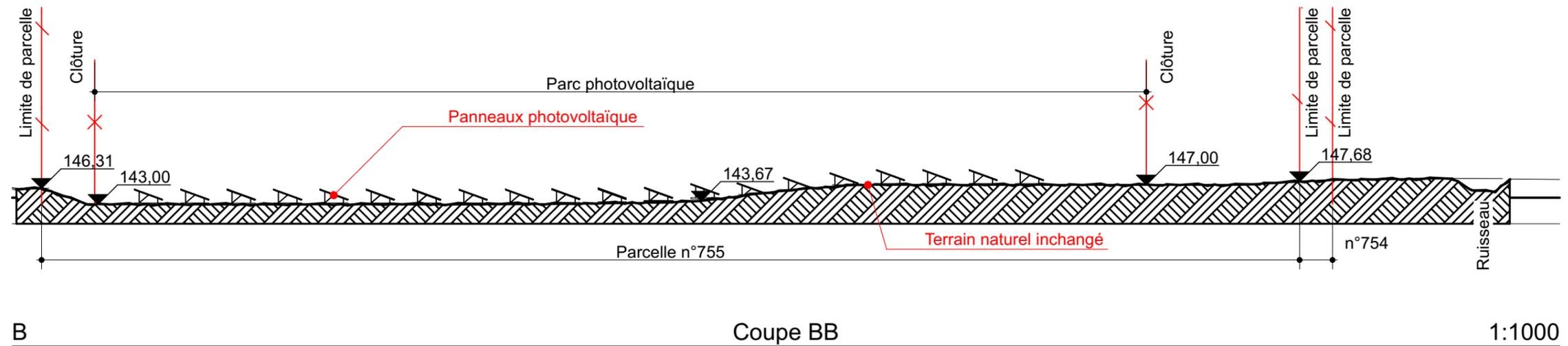
PC3. Un plan en coupe du terrain et de la construction [Article R. 431-10 b du code de l'urbanisme]
