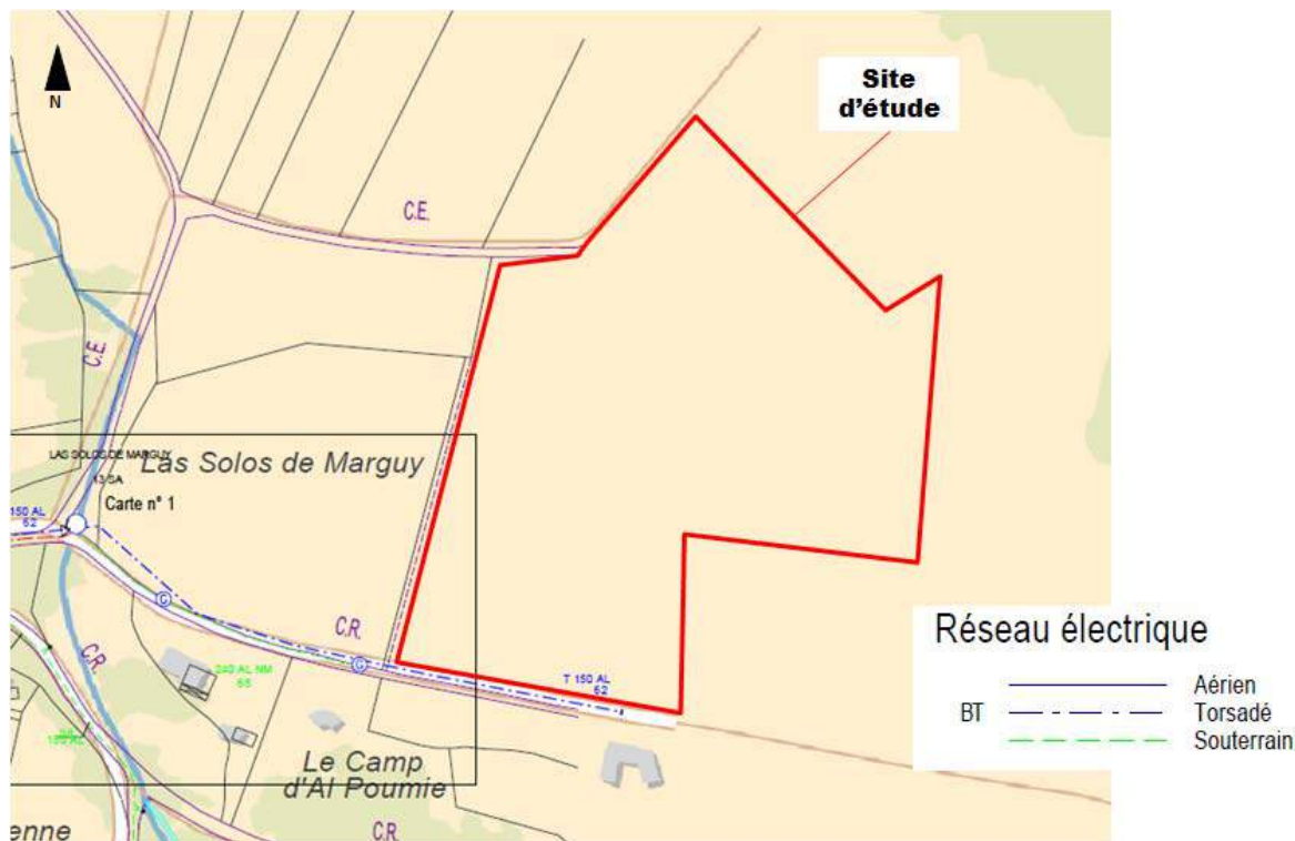
Réseau électrique à proximité du site d'étude (source : ERDF)
