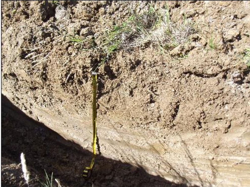
Figure 6 - Vue du sol plus profond riche en graviers et hydromorphie à partir de 30 cm
