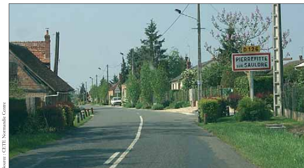
Exemple de positionnement du panneau d'entrée d'agglomération : à sa hauteur, on peut remarquer la présence du bâti rapproché, l'accotement de la rase campagne se transforme en espaces piétons et de stationnement de qualité, le marquage axial s'interrompt...
