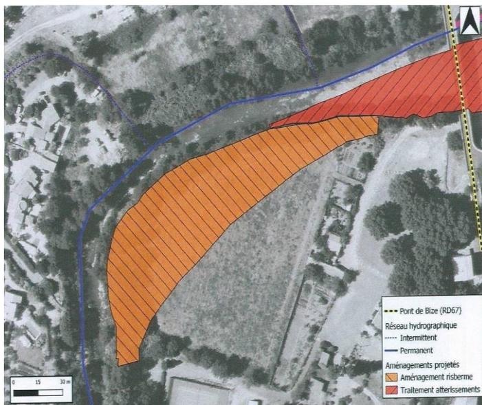
Ces travaux consistent à augmenter la section d'écoulement de la Cesse en crue afin d'abaisser la ligne d'eau en aval du pont de Bize. Ils consistent en un adoucissement du méandre par réalisation d'une terrasse surbaissée inondable sur la parcelle située à l'intrados du coude de la rivière côté rive gauche.
